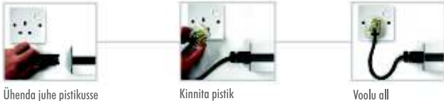
Joonis 06. Paigalduse võimalus 2- voolusiini paigaldamine seinakontaktiga ühenduse kaudu
